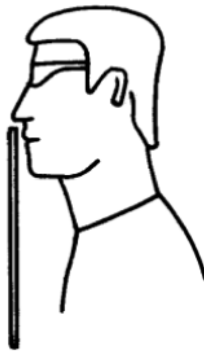
测针位于人体呼吸带内并平行于柜门平面
